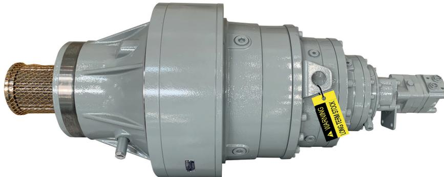
En el interior de la bolsa VpCI, se podrá ver en la superficie del reductor, una etiqueta atada con un cordel con la leyenda “**ATENCIÓN - ALMACENAMIENTO POR PERÍODO PROLONGADO**”:
