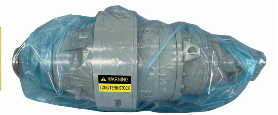
La unidad embalada dentro de una VpCI se identifica con una etiqueta adhesiva específica con la leyenda “**ADVERTENCIA ALMACENAMIENTO POR PERÍODO PROLONGADO**” en la superficie externa de la bolsa VpCI.
