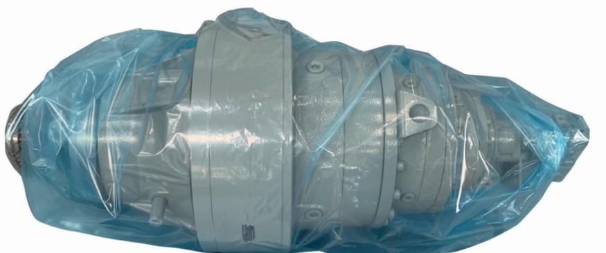
Dentro del contenedor, la unidad está protegida por una bolsa VpCI (Vapor phase Corrosion Inhibitor):
